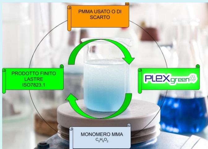
Il materiale da riutilizzare viene internamente trasformato attraverso un processo di depolimerizzazione degli sfridi (scarti) industriali di PMMA nel monomero MMA dal quale si ottengono nuove resine acriliche
